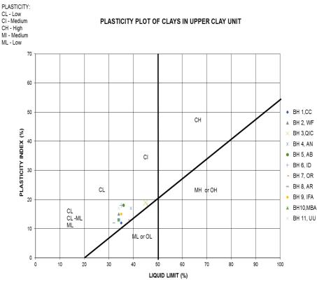
FIGURE 3. PLASTICITY PLOT OF UPPER CLAYS
